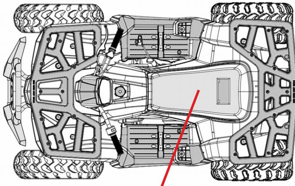
Расположение главного предохранителя
