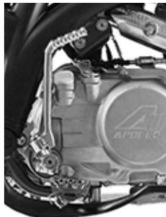
Двигатель мотоцикла оснащен 4-х ступенчатой коробкой передач.
