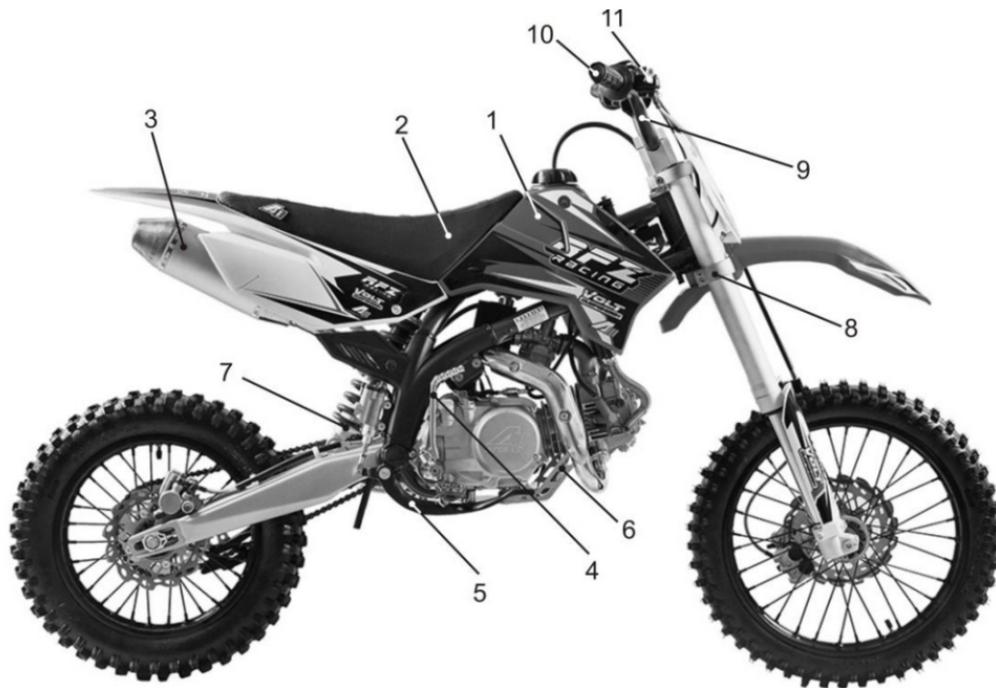
1 - топливный бак, 2 - сиденье, 3 - глушитель, 4 - кикстартер, 5 - педаль заднего тормоза, 6 - защита двигателя, 7 - задний амортизатор, 8 - передняя амортизационная вилка, 9 - руль, 10 - рукоятка дросселя, 11 - рычаг переднего тормоза.
