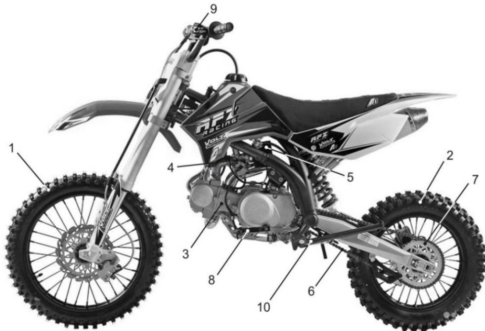
1 - переднее колесо, 2 - заднее колесо, 3 - двигатель, 4 - карбюратор, 5 - воздушный фильтр, 6 - приводная цепь, 7 - ведомая звезда привода, 8 - лапка переключения КПП, 9 - рычаг сцепления, 10 - стояночная подставка.
