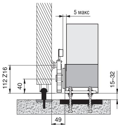
3. Наметьте точку сверления на воротах. Просверлите отверстие 6,5 мм и нарежьте резьбу с помощью метчика М8. Закрутите болт.
