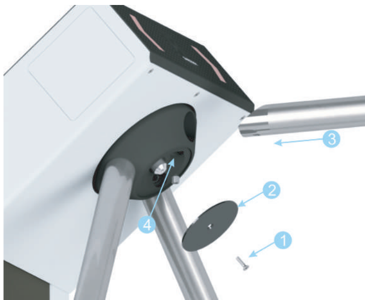
Рисунок 7.5.1 – Установка стандартной преграждающей планки.
