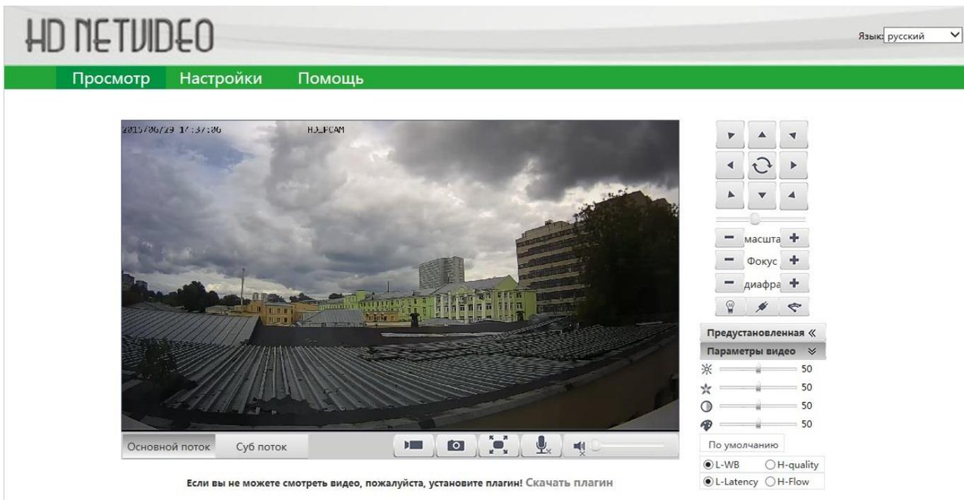
По умолчанию открывается вкладка «*Просмотр*» (мониторинг) камеры. Если окно интерфейса открылось, а изображения от камеры нет, кликните мышью «*Скачать плагин*», при этом камера сама предложит загрузить и установить плагин просмотра изображения. Соединение с интернетом при этом не
