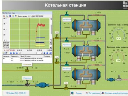
Общий вид АРМ оператора котельной станции в Trace Mode
