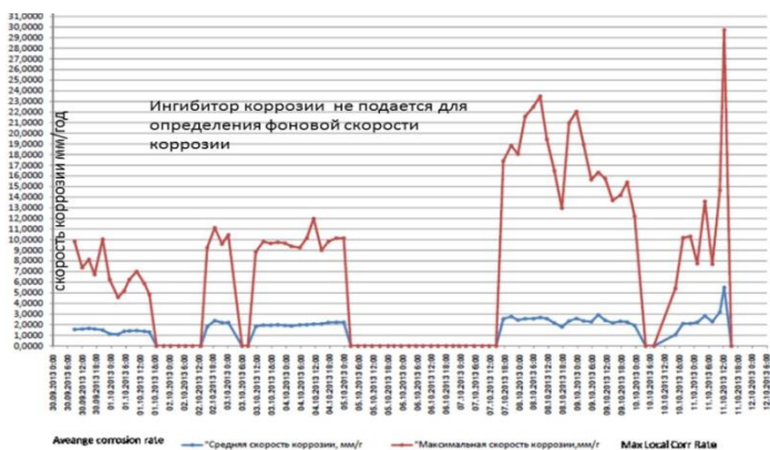
Замеры скорости коррозии в автоматическом режиме
