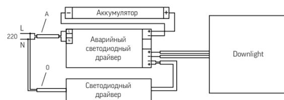
Рис. 3 Схема подключения аварийного даунлайта
