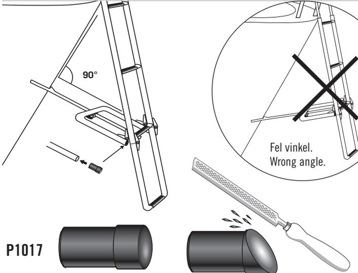
Justeringsplugg, för fallande stäv. Slipas i änden för önskad vinkel (staget ska ha 90° vinkel mot stäven) / Alignment dowels, for falling prow. Shape the end of dowel for desired angle (strut should have a 90° angle towards the bow).
