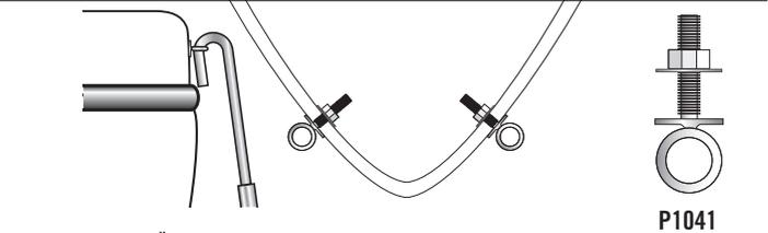
**ALTERNATIV 4:** Öglefästen som monteras direkt i skrovet. /
