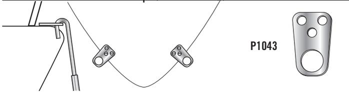
**ALTERNATIV 3:** Platta öglefästen monteras direkt på skrovet. /
