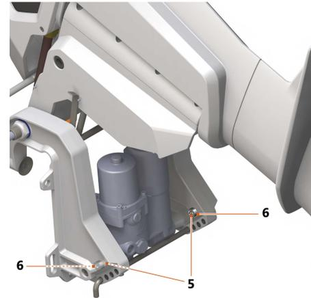
Abb. 36: Opferanoden Spiegelhalterung
