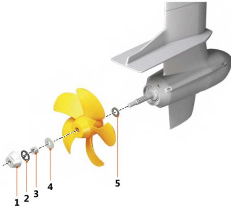
Abb. 9: Propellerbefestigung
