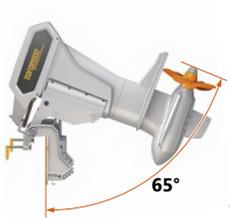
Abb. 31: Motor vollständig hochgekippt
