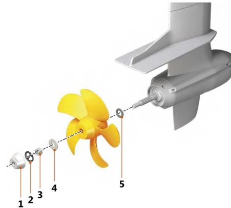
Abb. 33: Propellerbefestigung
