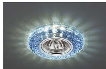
Они могут устанавливаться как в подвесные, так и в натяжные потолки. Светильники оборудованы драйвером для подключения светодиодной подсветки для прямого включения в сеть 220В и в качестве основного источника света, рассчитанные на напряжение питания 12В с цоколем GX5.3.
