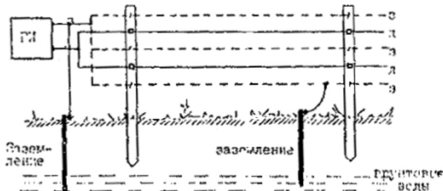
Рис. 10. Электроизгородь для районов с увлажненными почвами (более 700 мм осадков в год)
