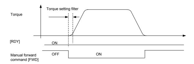
Use parameter PA1\_60 to specify the torque setting filter.
