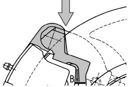
6) Если направляющая задевает о тормозной диск, то проточите её напильником, пока не образуется зазор.
