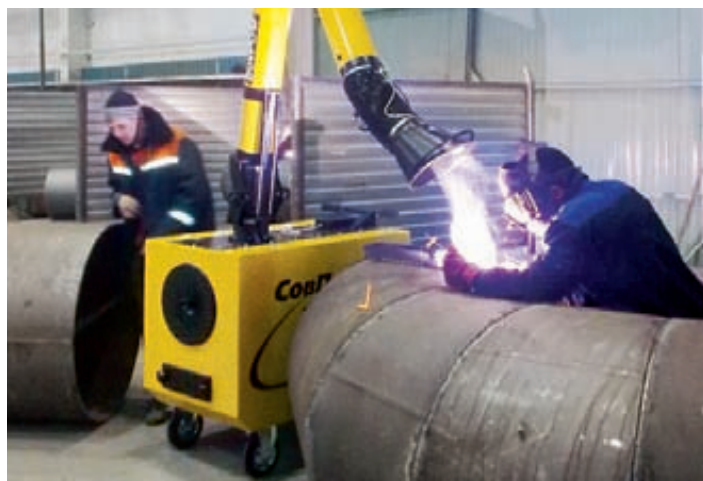
Стандартный передвижной самоочищающийся фильтр
