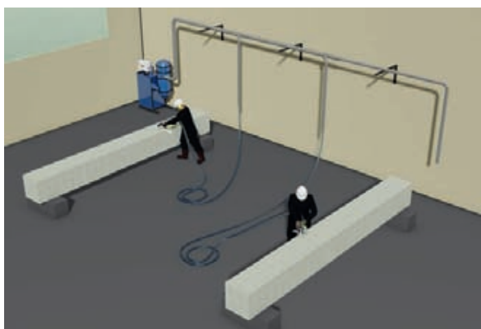
Удаление пыли от ручного инструмента при шлифовке конструкций на базе стационарной вакуумной системы
