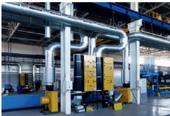
Система Push-Pull на базе фильтра MDB производства СовПлим (Россия)
