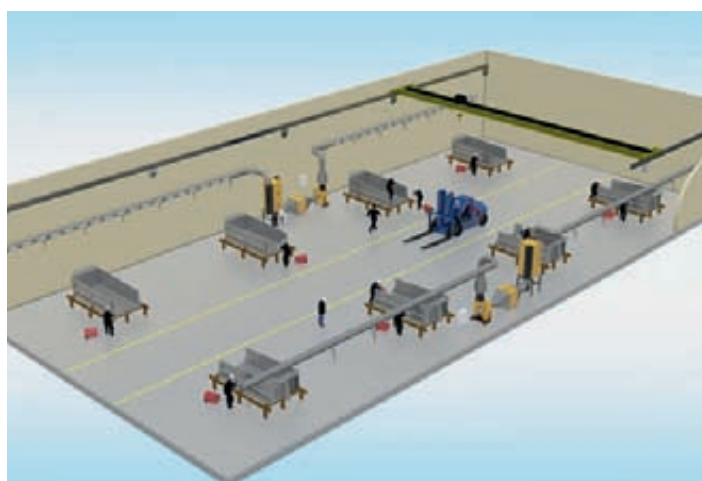
Параллельная система Push-Pull в сварочном цехе
