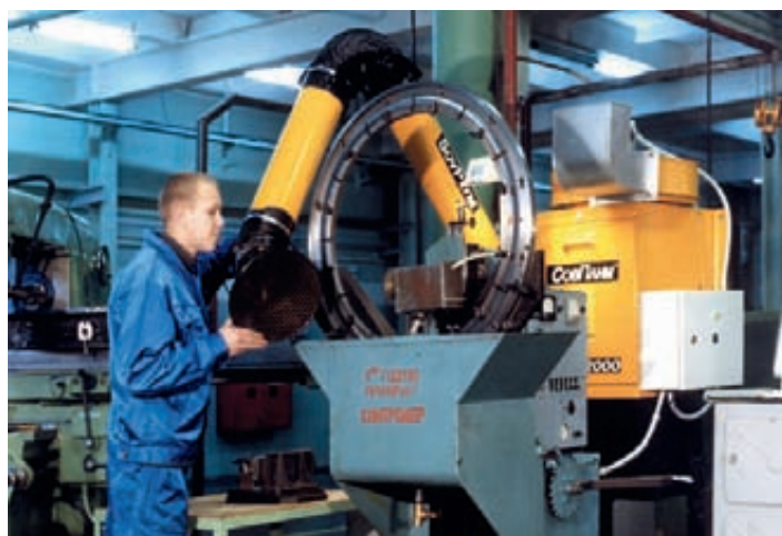
Рабочее место, оборудованное электростатическим фильтром EFO с вытяжным устройством
