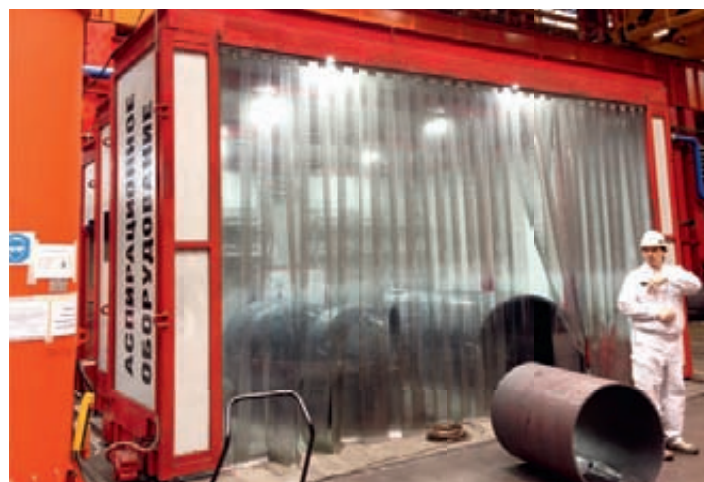
Телескопическая кабина для сварки и зачистки
