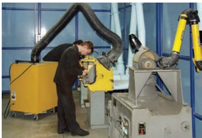
Передвижной механический фильтр со сменными кассетами на участке заточки инструмента
