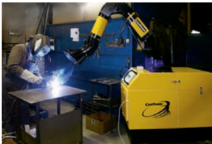
Передвижной самоочищающийся фильтр увеличенной производительности для особо дымных процессов
