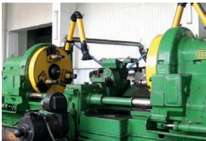
Удаление масляного дыма при расточке колесных пар
