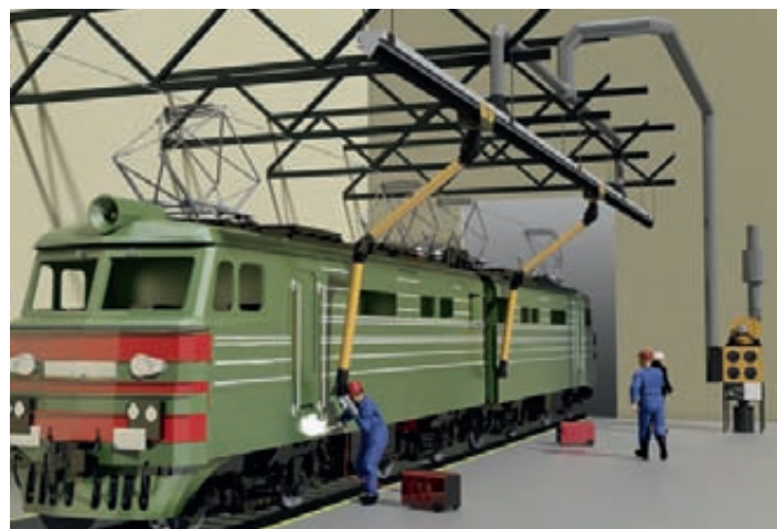
Вытяжные системы для длинномерных конструкций
