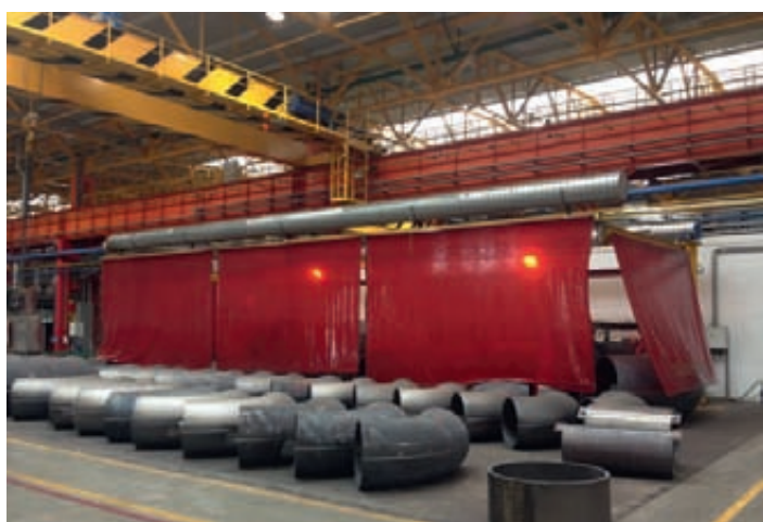
Ограждение участка строжки с системой Push-Pull
