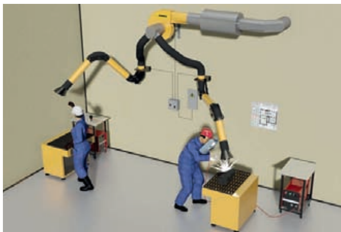
Вытяжная система с центральным вентилятором для одного-двух сварочных постов
