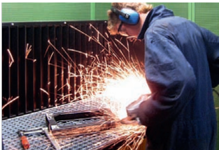
Сварочно-зачистной стол с верхним подключением к системе удаления и очистки воздуха
