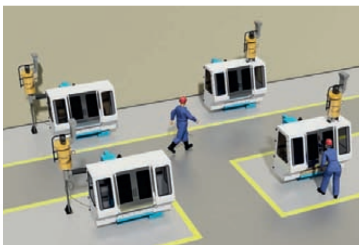
Станки с подключением к индивидуальному фильтру очистки воздуха от масляного тумана
