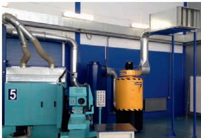
Удаление пыли от станка ЧПУ
