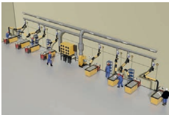
Вытяжная система с центральным вентилятором и системой очистки и возврата очищенного воздуха в помещение
