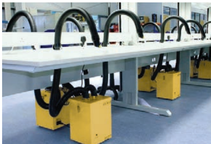
Настольные вытяжные устройства, оснащенные фильтрами LF-300 с низким уровнем шума
