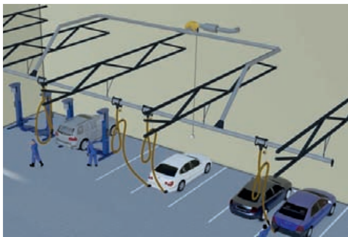
Применение пряморельсовой системы STP для стационарных постов обслуживания автомобилей
