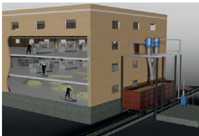
Общепроизводственная уборка на базе стационарной вакуумной системы
