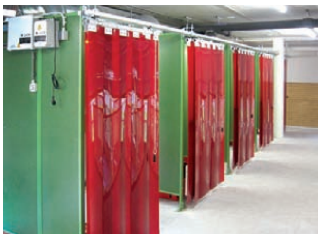
Защитные ограждения рабочих зон
