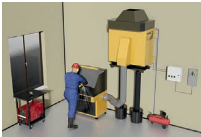
Сварочно-зачистной стол с боковым подключением системы удаления и очистки воздуха
