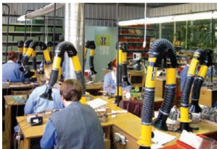
Цех пайки, оснащенный большим количеством настольных вытяжных устройств
