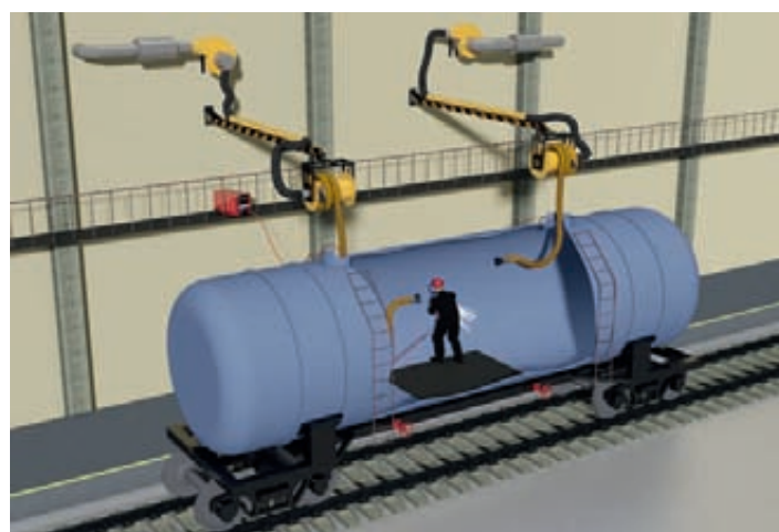
Вытяжная система для сварки в цистерне
