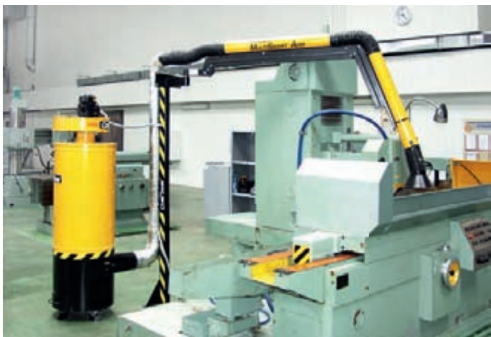
Удаление пыли от плоско-шлифовального станка
