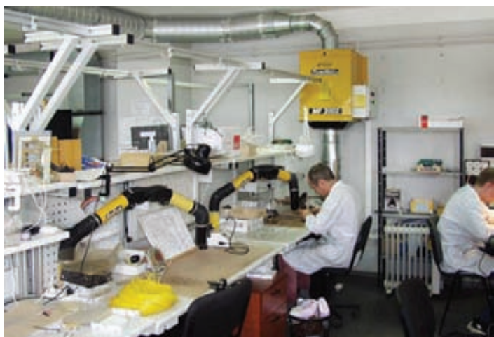
Участок пайки с настольными вытяжными устройствами, подключенными к настенному механическому фильтру
