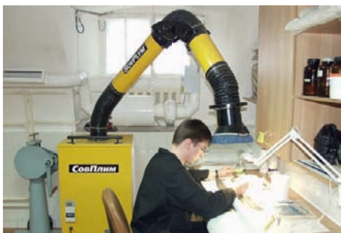
Передвижной фильтр со сменными кассетами в реставрационной мастерской
