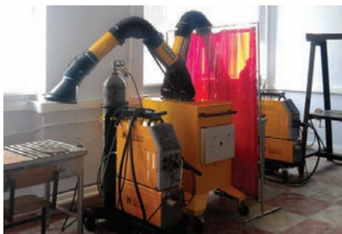
Передвижной электростатический фильтр с двумя вытяжными рукавами в учебном классе
