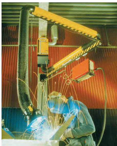
Вытяжное устройство, установленное на монтажной колонне.
