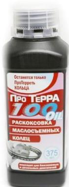
Прогреть двигатель до температуры не ниже 50°C, Залить «ПроТерра 100-Оil Раскоксовка маслоъемных колец» в маслозаливную горловину, 1 банка на 4-6 литров масла в двигателе. Запустить двигатель, прогреть до максимальной рабочей температуры. Установить обороты двигателя в 1500-2000 об/мин в течение 15-20 мин. Заменить моторное масло и масляный фильтр (обязательно).
