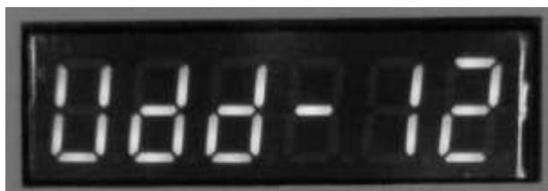
Рис.1- Стандартное положение, **таймер в режиме ожидания** ( Вольтметр – показание значение АКБ).
