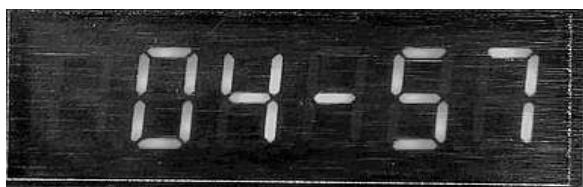
Рис.2 -Таймер запущен на 5 минут, по окончанию электричество отключается.
