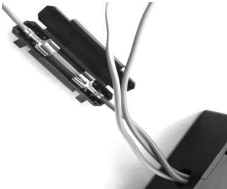
Рис.4 - Фото предохранителя на минусовом проводе ( синий цвет) под крышкой 20-25 Ампер 250V предохранитель.
