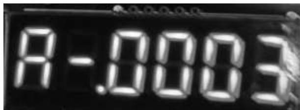
Рис.3 - Включен режим просмотра статистики, где Буква А это таймер пяти минутный (по умолчанию), где 0003 количество игр всего(Рис.3). до 9999
