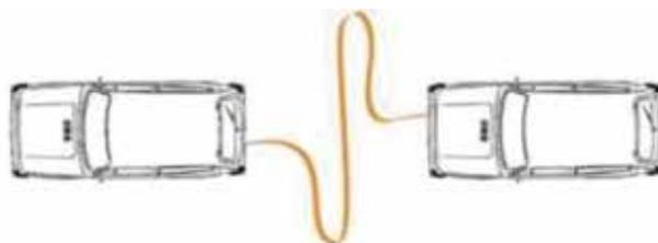
Эвакуатор должен двигаться по прямой линии (относительно эвакуируемого а/м) на столько, на сколько это возможно. Если отклонение составляет более 15°, то рекомендуем использовать строп-балансир нагрузок или специальный строп для эвакуации "МС" (для этих случаев необходимо наличие двух точек крепления на а/м).
