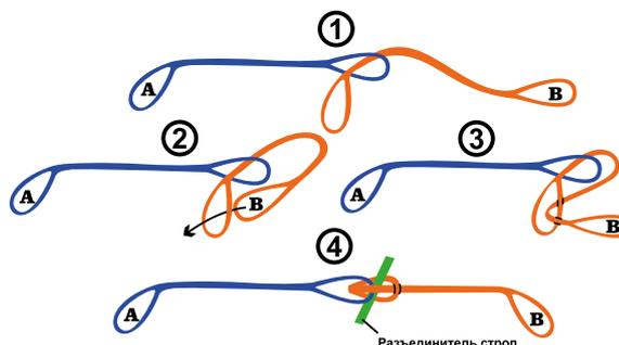
Не допускается использовать шакл для соединения двух строп!
