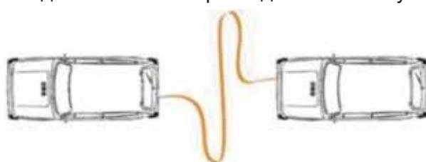
Эвакуатор должен двигаться по прямой линии (относительно эвакуируемого а/м) на столько, на сколько это возможно. Если отклонение составляет более  $15^\circ$ , то рекомендуем использовать строп-балансир нагрузок или специальный строп для эвакуации "MC" (для этих случаев необходимо наличие двух точек крепления на а/м).
