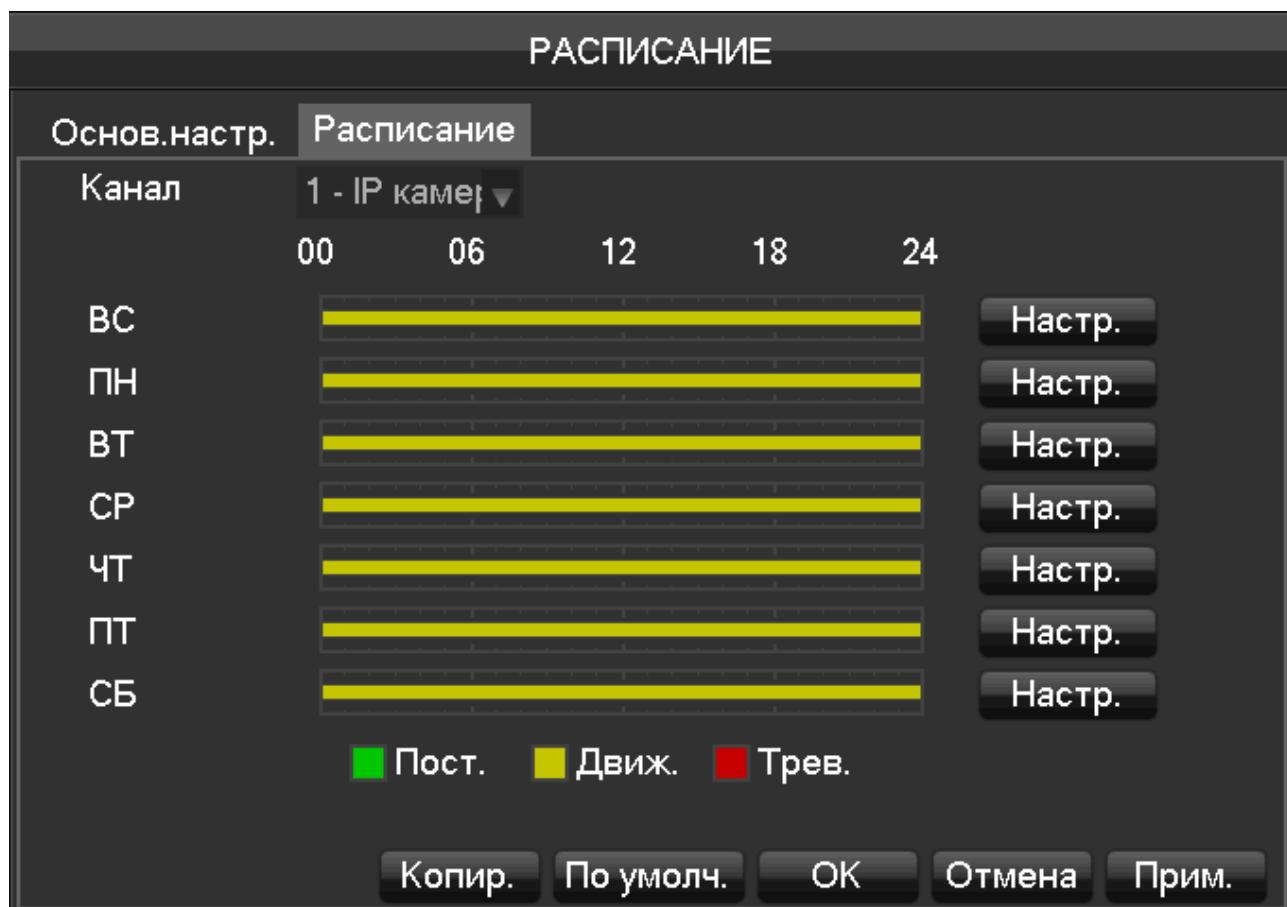
[Канал] (Channel) - выбор канала. Зеленый цвет означает обычный режим записи, желтый - режим обнаружения движения, а красный - режим сигнализации. Пользователи могут устанавливать или менять настройки в зависимости от даты. [Копир.] (Copy) - скопировать текущие настройки для других каналов. Нажмите [Настр.] (Set) и вы войдете в интерфейс работы с графиком записи.
