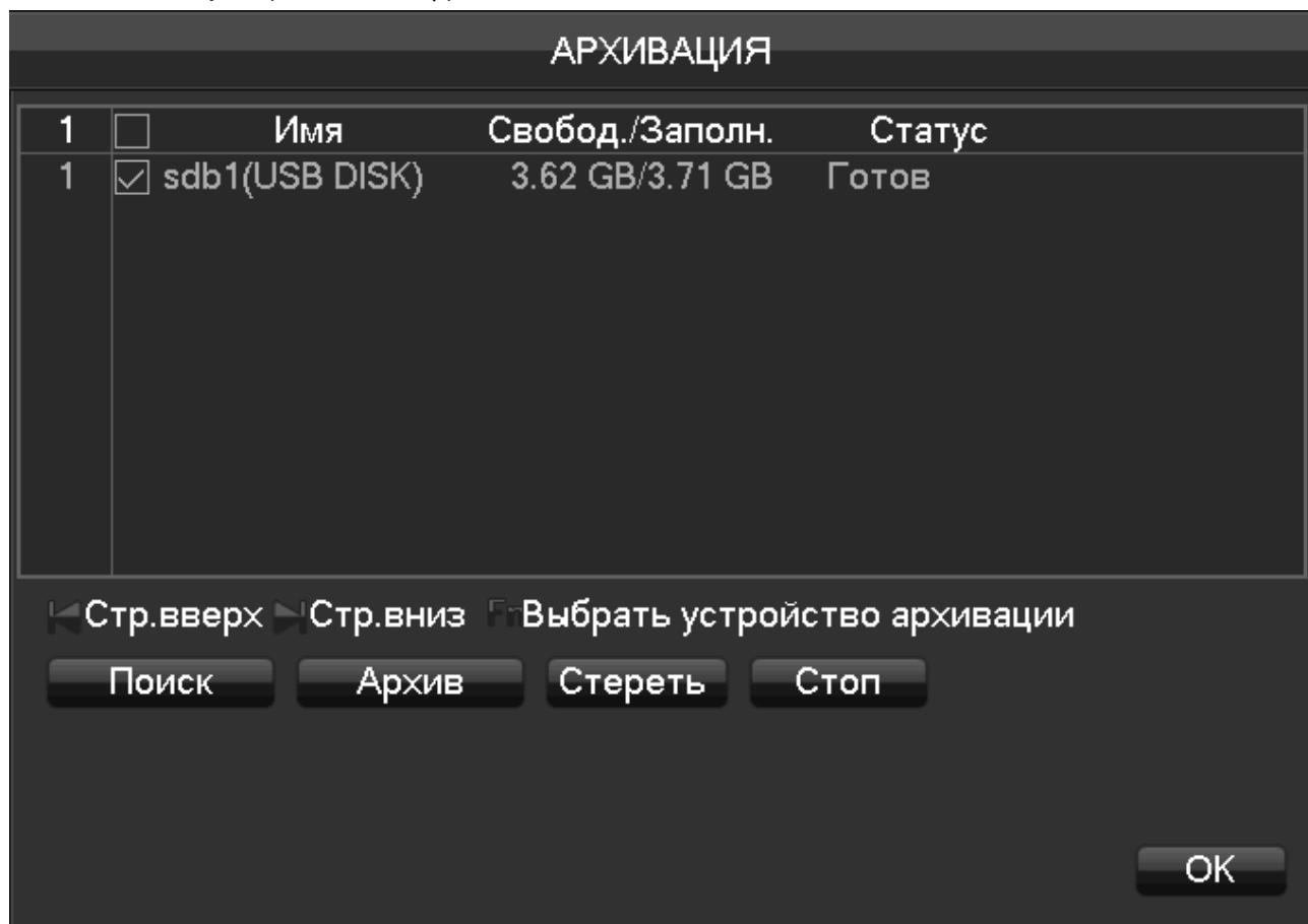
[Поиск] (Detect) - распознавание внешнего USB-устройства хранения данных и отображение информации о нем.
