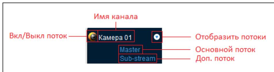
Щелкните по поз. 2 в верхнем правом углу и вы сможете открыть/закрыть окно канала основного или дополнительного потока данных, где отображается IP регистратора и информация о скорости передачи данных.
