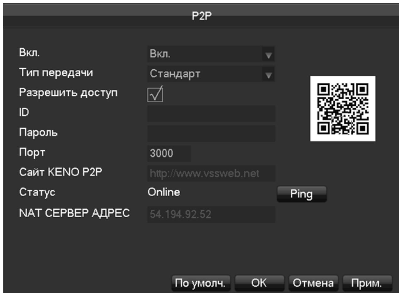
[Вкл.] (Enable) - включает и выключает функцию P2P.
