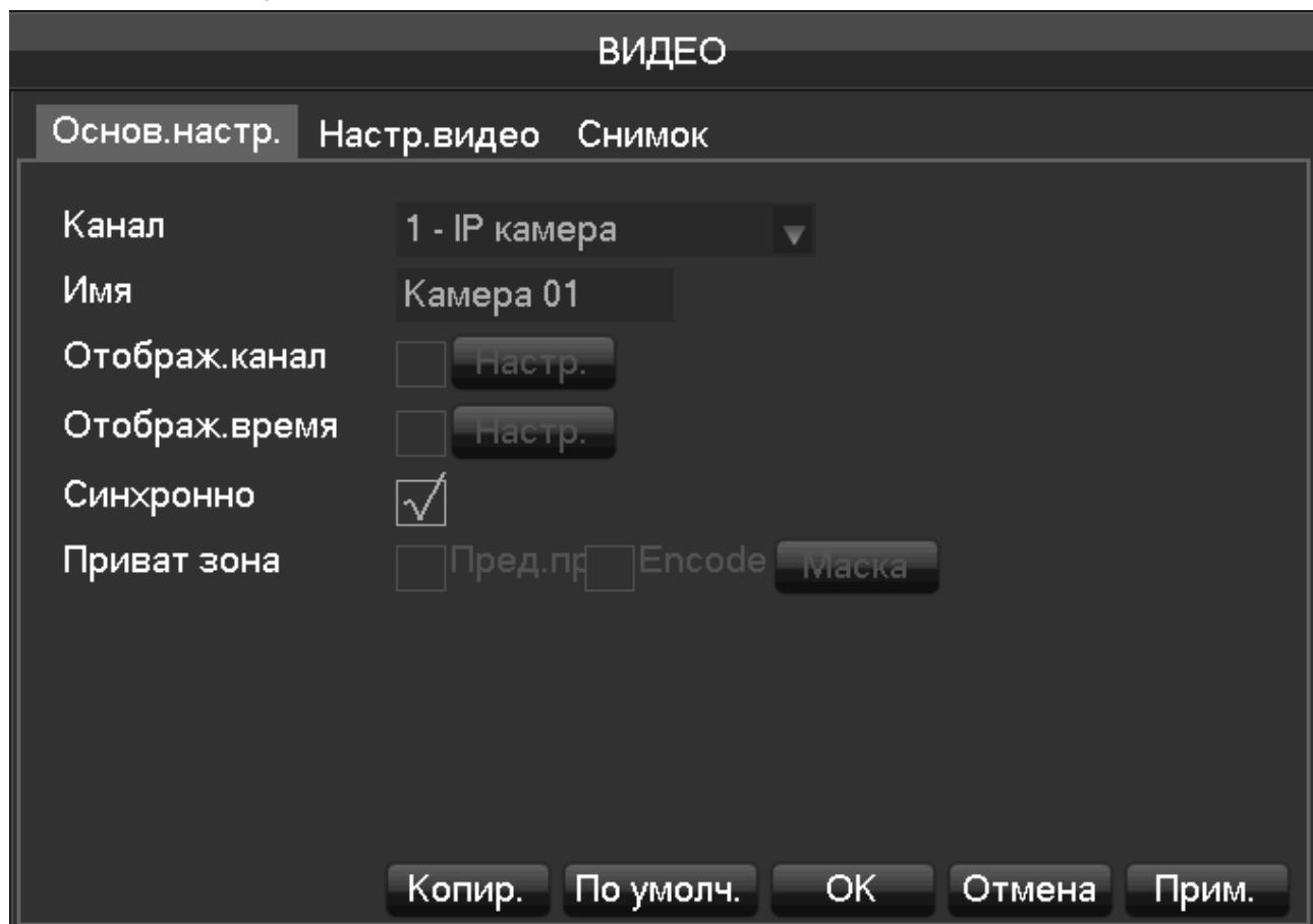
[Канал] (Channel) - позволяет выбрать номер канала, настройка которого будет выполняться;
