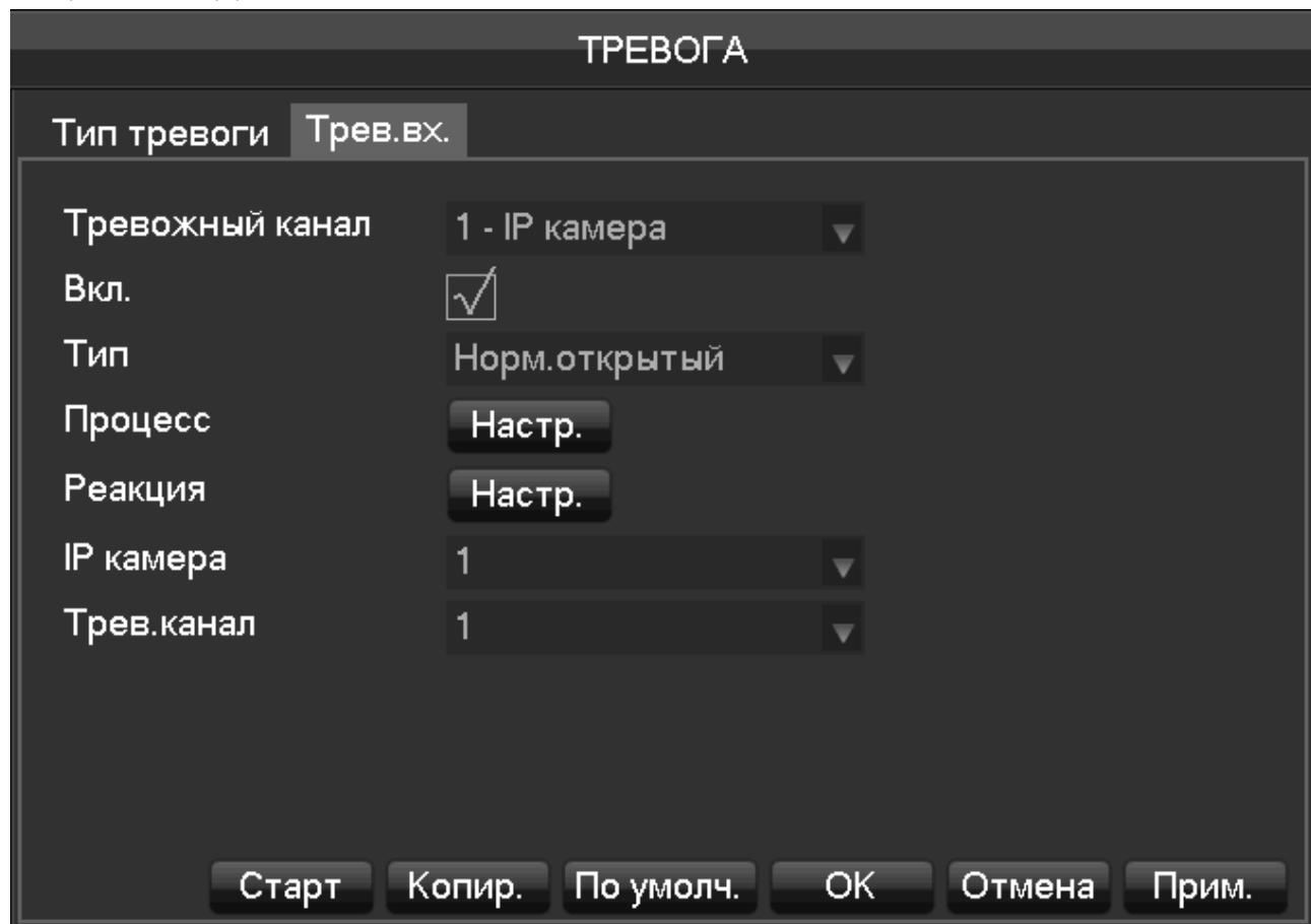
[Тревожный канал] (Alarm input channel no) - выберите канал.
