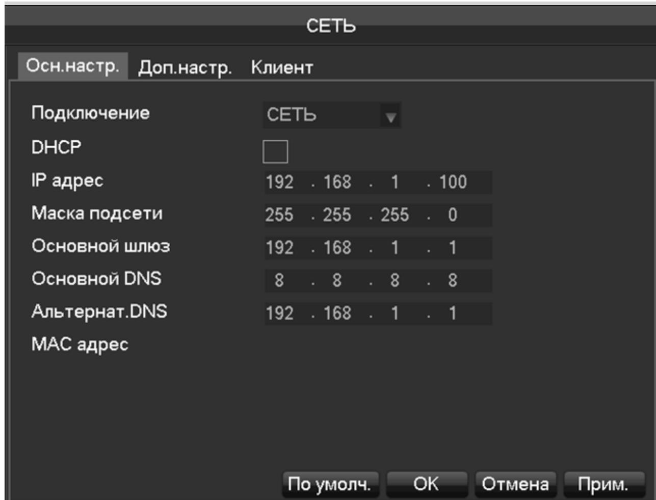
[Подключение] (Network Card Type) – «СЕТЬ» параметры сети регистратора, «СЕТЬ2» – параметры встроенного POE коммутатора (зависит от модели устройства).
