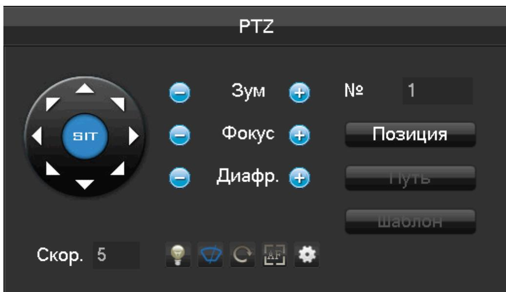
С помощью функции управления PTZ можно управлять следующими параметрами: направление, интервалы, фокусировка, диафрагма, контрольные точки, движение между контрольными точками, патрулирование, перемещение границ, замыкание дополнительного контакта, включение освещения, горизонтальное вращение.
