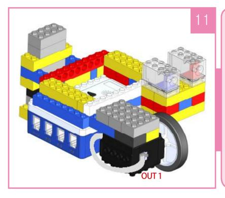
• Подключите двигатель постоянного тока к OUT1 блока процессора.
