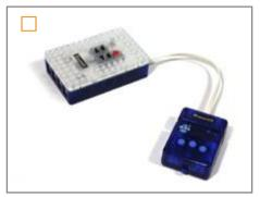
Присоедините устройство для считывания карт к R/D портам на блоке ЦПУ с помощью кабелей.
