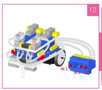
• Подключите инфракрасный датчик проводом 450mm к IN 1, IN 2, IN 3 блока процессора.
