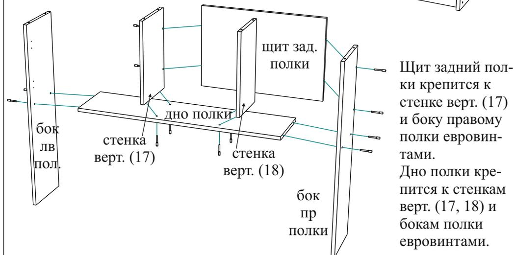
Щит задний полки крепится к стенке верт. (17) и боку правому полки еврвинтами. Дно полки крепится к стенкам верт. (17, 18) и бокам полки еврвинтами.
