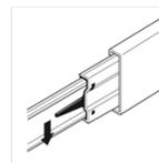
Направляющие разъединяются с помощью нажатия пластикового рычажка при вытягивании внутреннего полоза.
