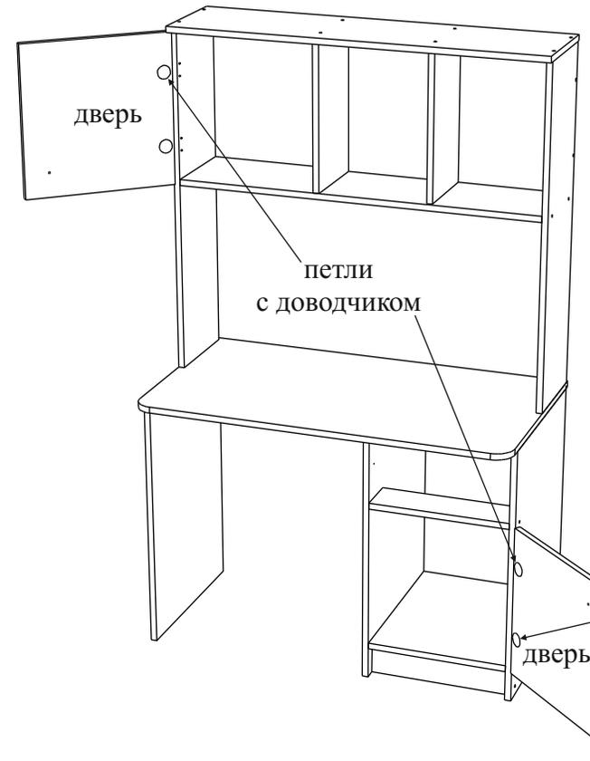
Петли 4-х шарнирные крепятся к боку левому полки и боку правому тумбы саморезами 4.0\*16, к дверям - саморезами 4.0\*12.
