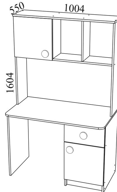
Габаритные размеры: длина - 1004 мм, высота - 1604 мм, глубина - 550 мм.
