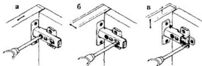
**Схема регулировки дверей после навески на корпус:**
