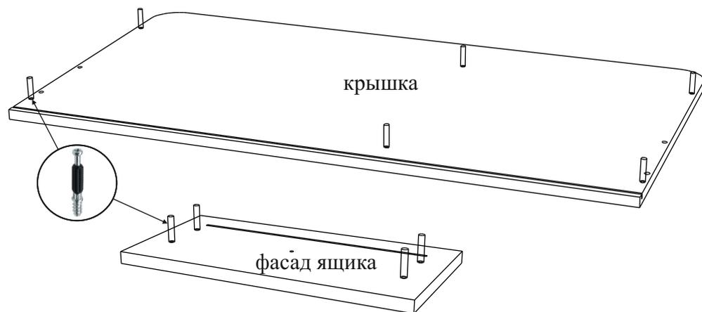
На бока тумбы устанавливаются шканты. По наколкам на боках тумбы и боках ящика проводятся горизонтальные осевые линии. Направляющие устанавливаются отверстиями на линию и крепятся саморезами 3.5\*16, присадочное отверстие считать первое от фасада.
