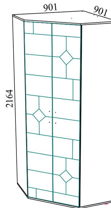
Габаритные размеры: длина - 901 мм, высота - 2164 мм, глубина - 901 мм.
