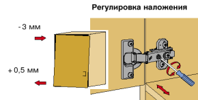
Рис.1 Схема регулировки петли
