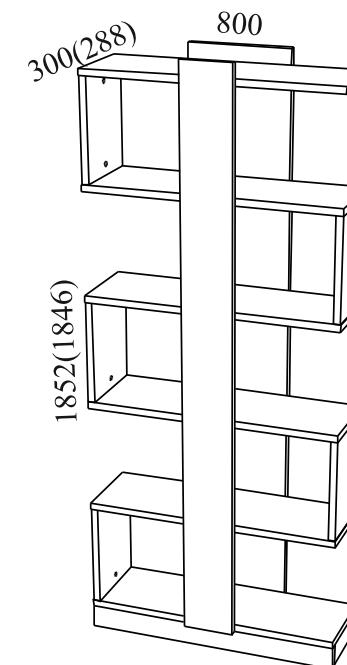
**Габаритные размеры: ширина - 800 мм, высота - 1852(1846) мм, глубина - 300(288) мм.**
