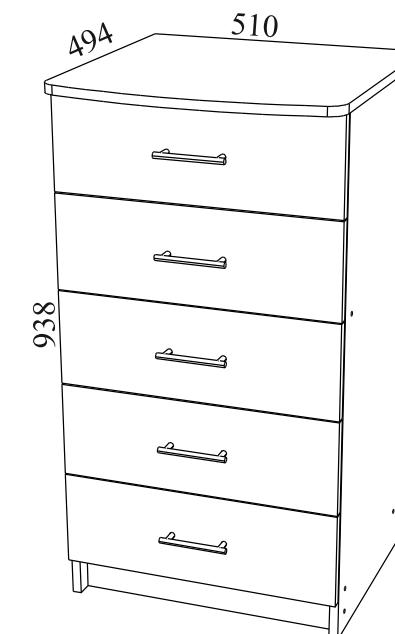
Габаритные размеры: ширина - 510 мм, высота - 938 мм, глубина - 494 мм.
