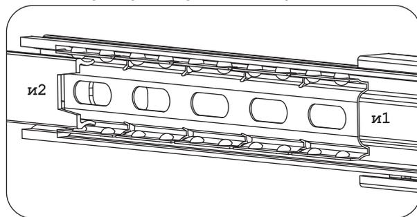
Для соединения нескольких шкафов между собой необходимо досверлить отверстия  $\varnothing 6$  с изнаночной стороны соседних боковин.
