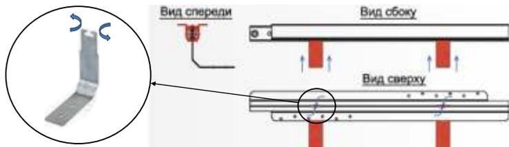
Механизм крепится по наколкам к крышкам саморезами 4.0\*20, крючки к панели - саморезами 4.0\*16.
