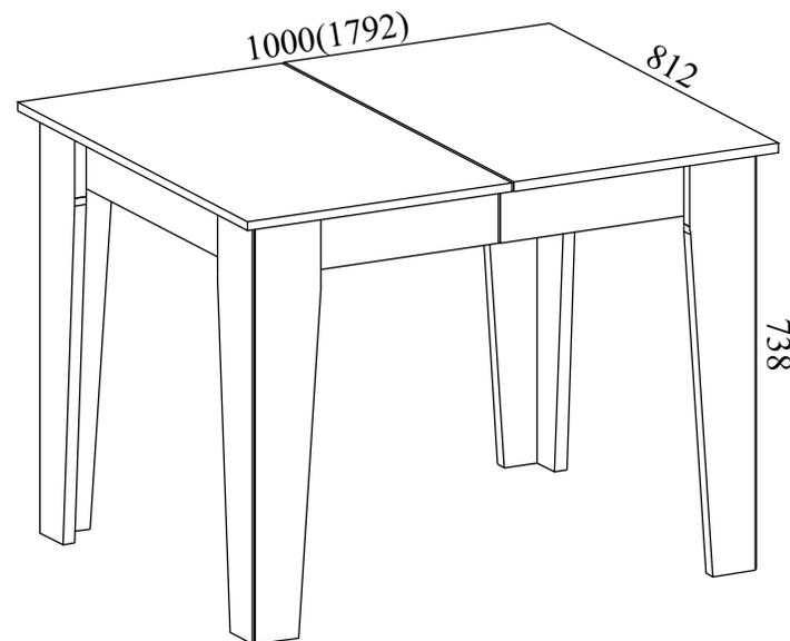
Габаритные размеры: длина - **1000(1792) мм**, высота - **738 мм**, глубина - **812 мм**.
