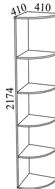
Габаритные размеры: длина - 410 мм, высота - 2174 мм, глубина - 410 мм.
