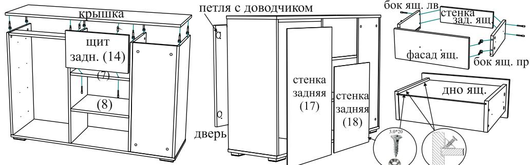
Бока ящика крепятся к стенке задней ящика евровинтами, к фасаду ящика - стяжками эксцентриковыми. Дно ящика вставляется в пазы и крепится к стенке задней ящ. саморезами 3.0\*20 (по 3шт. на ящ.) через шайбы метал. Держатели задней стенки вставляются в пазы под дно ящика и крепятся саморезами 3.0\*20 (по 2 шт. на сторону).
