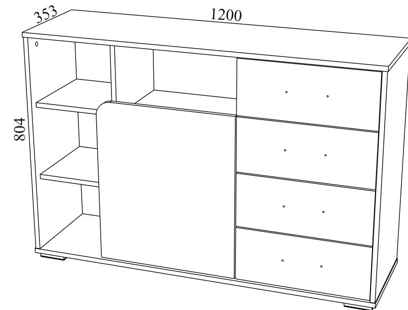
Габаритные размеры: ширина - 1200 мм, высота - 804 мм, глубина - 353 мм.
