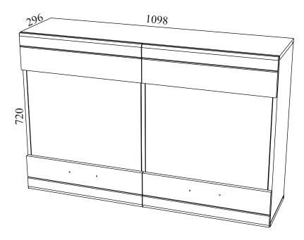
Габаритные размеры: длина - 1098 мм, высота - 720 мм, глубина - 296 мм.
