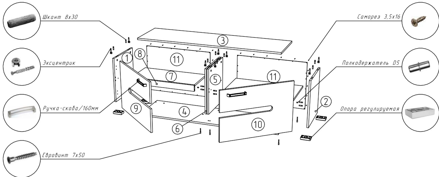
Рисунок 1 – Сборка каркаса
