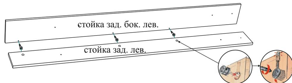
Стойки крепятся к собранной конструкции стяжками межсекционными.
