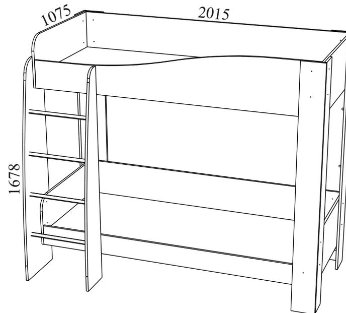
Габаритные размеры: длина - 2015 мм, высота - 1678 мм, глубина - 1075 мм.
