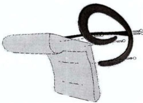
5. Закрутить до упора все винты и заклеить головки винтов самоклеящимися заглушками.
