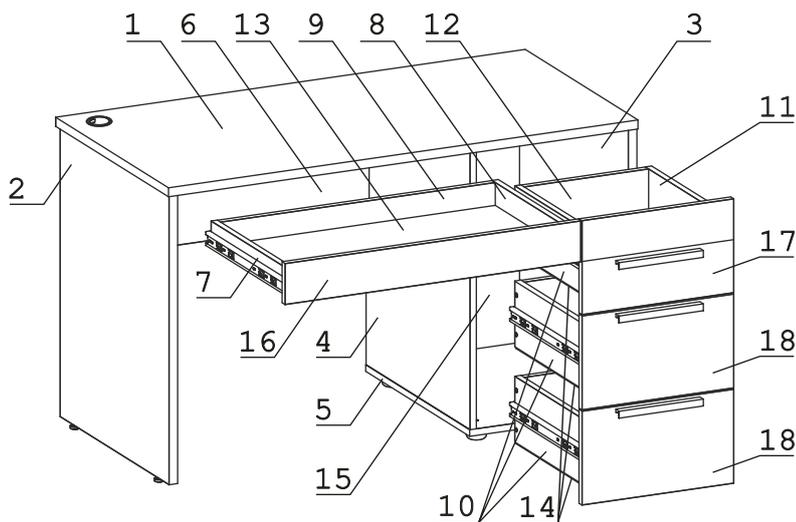
Перед началом сборки необходимо разъединить полновыкатные направляющие. Для этого максимально раздвинуть направляющую и нажать на пластиковый фиксатор. Далее выдвинуть внутреннюю часть из внешней.
