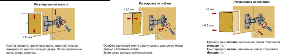
Рис.3 Схема установки подвески
