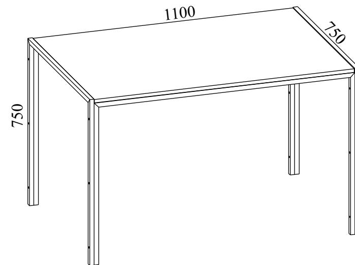
Габаритные размеры: длина - 1100 мм, высота - 750 мм, глубина - 750 мм.
