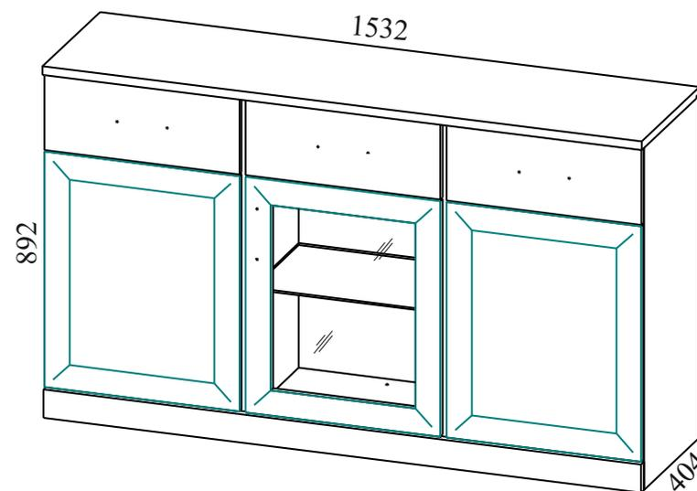
Габаритные размеры: ширина - 1532 мм, высота - 892 мм, глубина - 404 мм.
