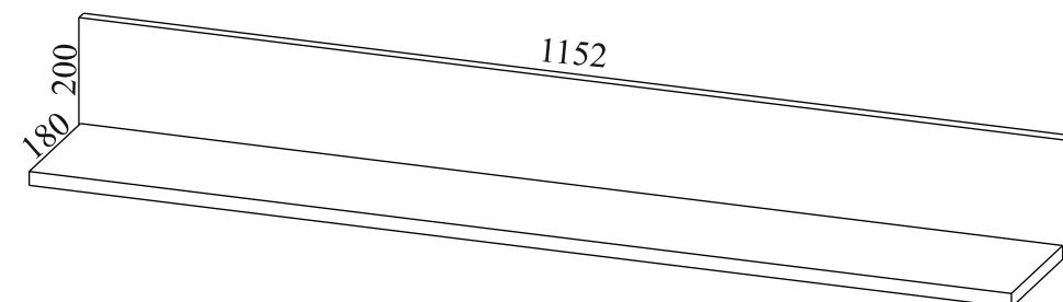
Габаритные размеры: ширина - 1152 мм, высота - 200 мм, глубина - 180 мм.
