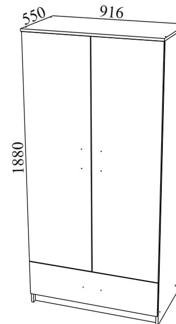
Габаритные размеры: ширина - 916 мм, высота - 1880 мм, глубина - 500 мм.
