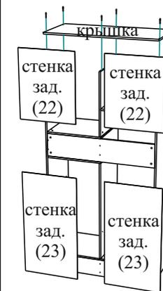
Крышка крепится к бокам и перегородке (4) евровинтами. Стенки задние крепятся к шкафу саморезами 3,0\*20 через шайбы металлические с шагом примерно 130 мм.
