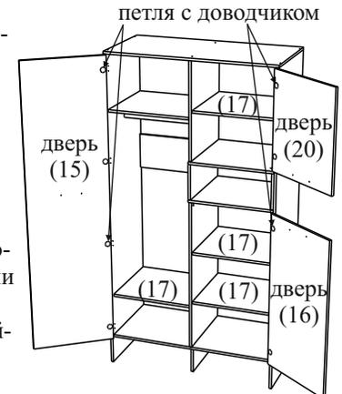
Штангодержатели крепятся к боку левому и перегородке саморезами 4,0\*16. По желанию, вместо двух полок в правой части шкафа, к боку правому и перегородке крепятся штангодержатели. Штанги устанавливаются на штангодержатели, полки - на полкодержатели.
