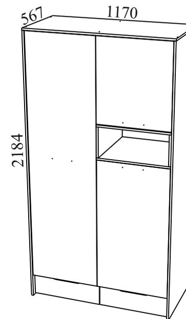
Габаритные размеры: ширина - 1170 мм, высота - 2184 мм, глубина - 567 мм.
