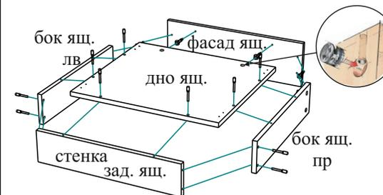
Бока ящика крепятся к стенке задней ящика евровинтами, к фасаду ящика - стяжками эксцентриковыми. Дно ящика крепится к фасаду ящ. стяжками эксцентриковыми, к бокам и стенке задней ящика - евровинтами. Ролики выкатные крепятся по местам наколок к дну ящика саморезами 4,0\*16.
