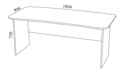
Габаритные размеры: длина - 1804 мм, высота - 750 мм, глубина - 904 мм.
