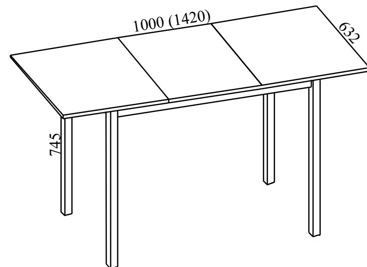
Габаритные размеры: длина - **1000(1420) мм**, высота - **745 мм**, глубина - **632 мм**.
