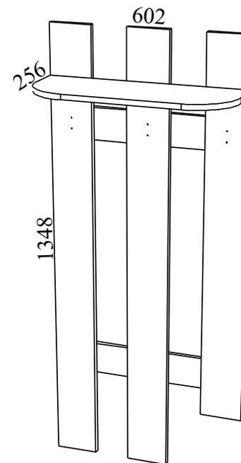
Габаритные размеры: длина - 602 мм, высота - 1348 мм, глубина - 256 мм.
