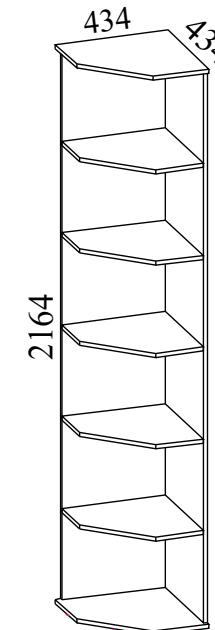
Габаритные размеры: длина - 434 мм, высота - 2164 мм, глубина - 434 мм.
