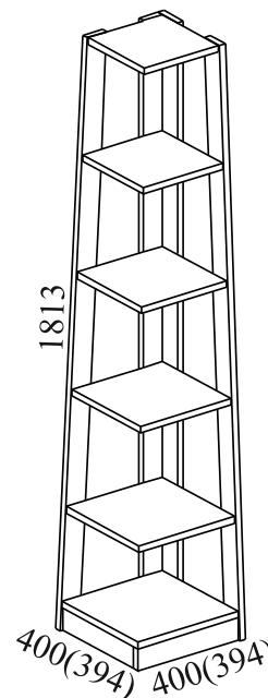
Габаритные размеры: ширина - 400(394) мм, высота - 1813 мм, глубина - 400(394) мм.
