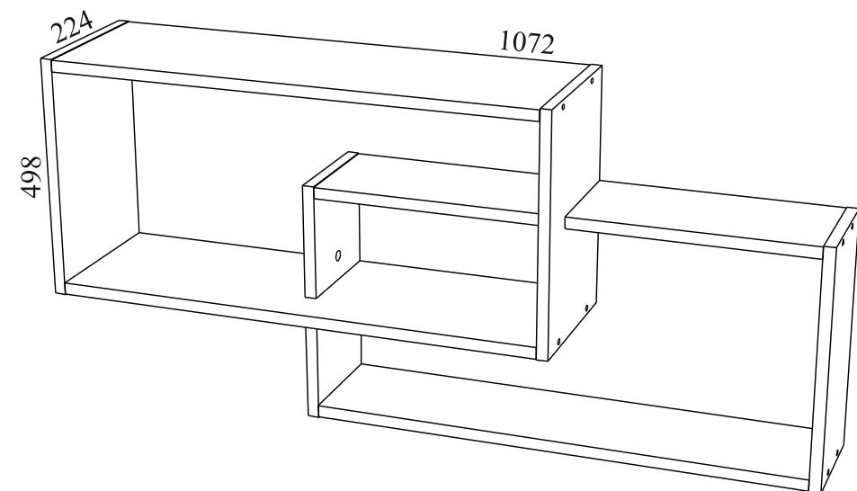
Габаритные размеры: ширина - 1072 мм, высота - 498 мм, глубина - 224 мм.
